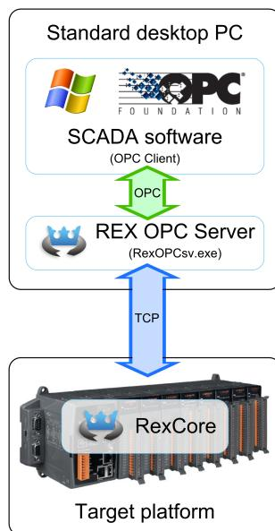
Pro výměnu dat je potřeba pouze v registrech systému Windows nastavit adresu cílového zařízení systému REXYGEN, se kterým si bude OPC server vyměňovat data. V registrech stačí najít klíč
