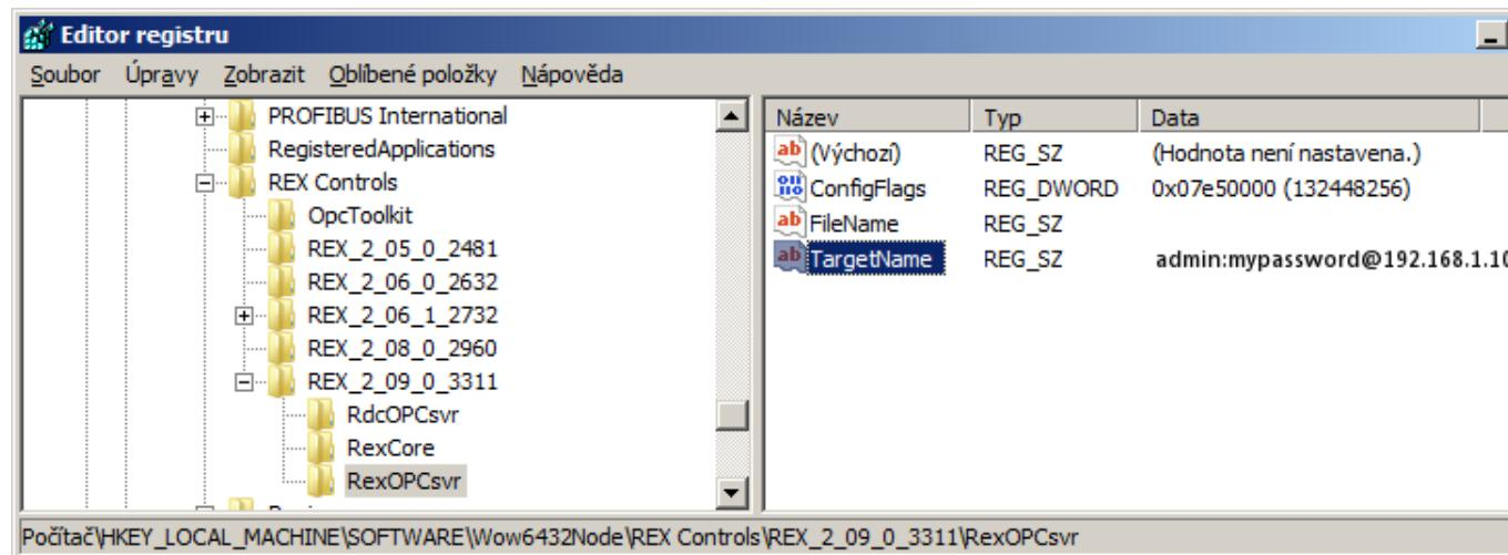
Následně je možné ve vývojovém prostředí vizualizačního softwaru nadefinovat propojení s běžící exekutivou systému REXYGEN. Přes OPC server **REXControls.RexOPCsvr** je možno číst všechny vstupy, výstupy a parametry všech funkčních bloků, ze kterých je běžící algoritmus sestaven. Zapisovat jde do parametrů bloků, případně na vstupy bloků, pokud na ně není v algoritmu přiveden jiný signál.
